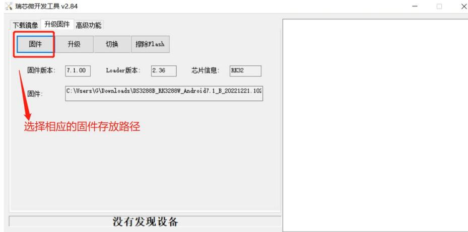
(4) 将设备断电，然后拿一个镊子对准按紧耳机孔里面的 U-Boot 按键，最后再给设备供电，电脑会识别设备，等待设备进入 LOADER 模式后，再松手，设备才会进行固件烧录。
